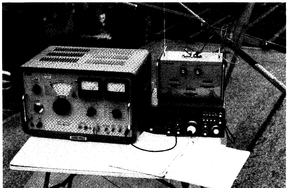
Fig. 14. Opstelling voor het meten van de impedantie aan de klemmen van een raam en aan de kabelzijde van een balun. De quad is hier nog in de Mk I-uitvoering met vishengels, zie deel 3 (foto: PA0SE).
