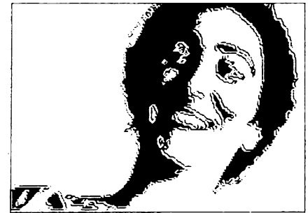
Fig. 26 Ingelezen en geplot met 'zwartsan' (met twee gelijke omslagwaarden). Nabewerkt met Beta Basic en programma 'contour'.
