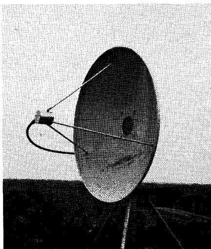
Met deze 80 centimeter grote schotel hoopt PAoWRC/p nog veel 9cm signalen te ontvangen.
