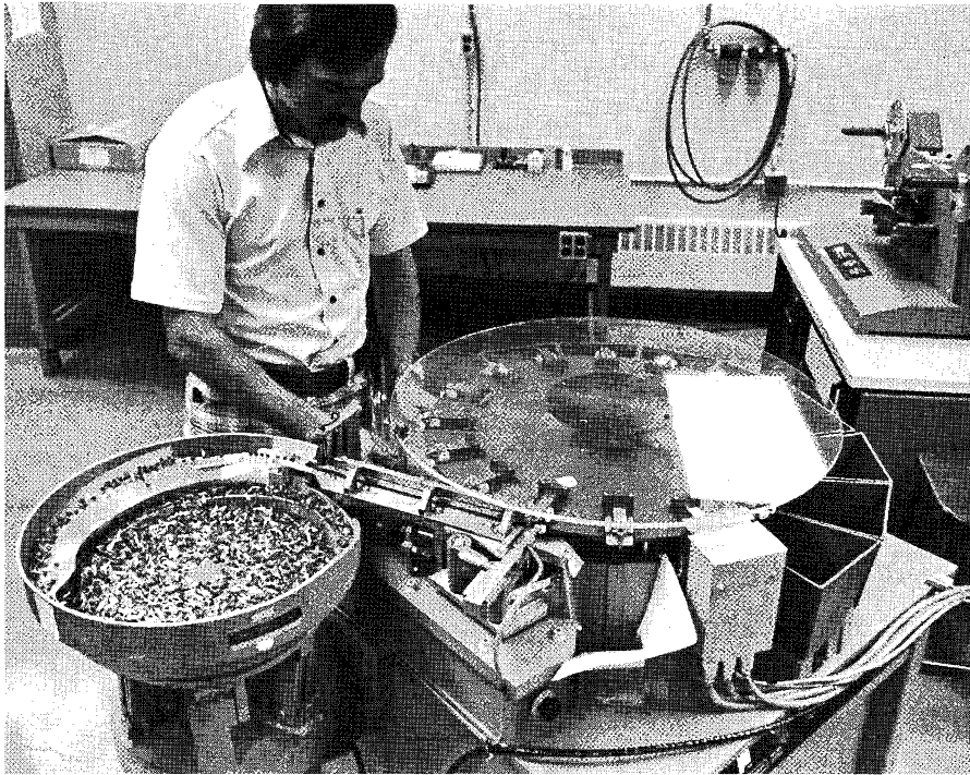
Het machinaal sorteren van transistoren naar tolerantie
