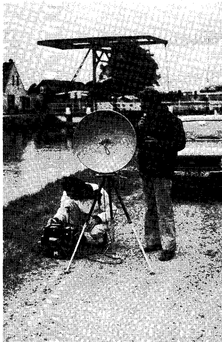
24 GHz experimenten. PAoKKZ tijdens de experimenten bij Hardenberg. Met de kijker op de voorgrond wordt zo nauwkeurig mogelijk de richting bepaald want de antennebundel is zeer smal. (Foto PDoDHM).
