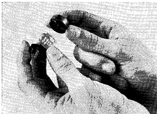
Hier ziet u de beide kernhelften van een P-potkern met het spoelkokerkje
