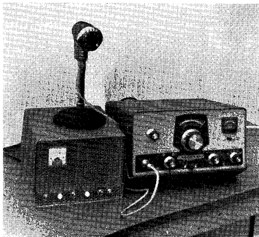
Vooranzicht van de Heathkit HW32A met daarbij een zelfgemaakt voedingsapparaat voor deze zendontvanger. Op de HW32A van links naar rechts: final tune, afstemming, S-meter met meterschakelaar. Daaronder eveneens van links naar rechts: de microfooningang, h.f.- en l.f.-regeling, USB/LSB schakelaar, microfoonversterking en functieschakelaar: off-p.t.t.-vox-cal.
