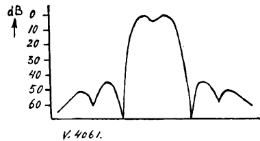
Fig. 21. Karakteristiek van een filter met twee secties, bij te sterke neutrodynisatie
