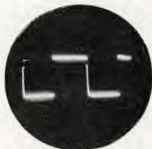
Foto 1 - Uscita del circuito di figura 6 realizzato con transistori PNP con h_{FE} = 200
