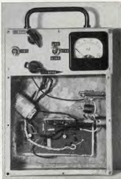
Come si presenta l'interno della parte più strettamente «metrica» del cercametalli.
