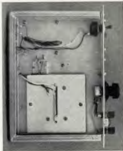
Vista inferiore A destra si nota la piastra di raffreddamento degli OC26
