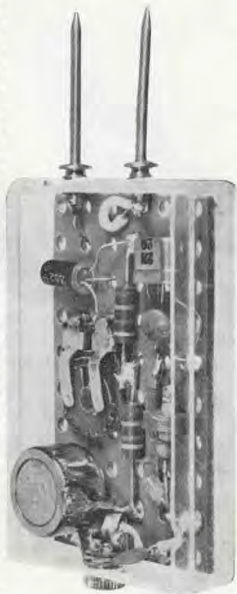
Il misuratore aperto; si notano bene la piletta da 1,34 V, i due transistori e il diodo.
