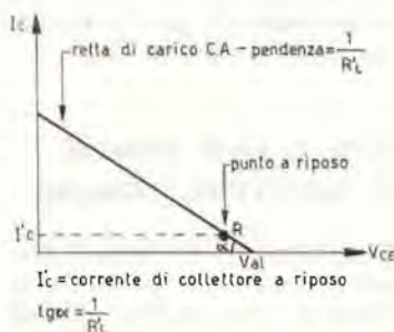
Figura 6 Retta di carico di un transistoro della classe B
