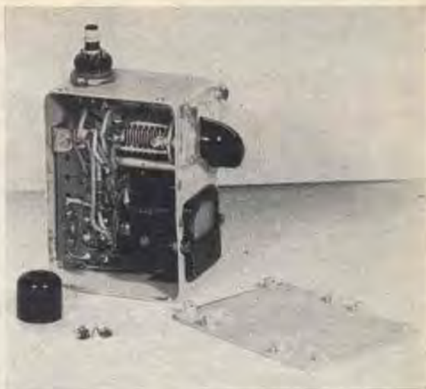
Il transi-dip aperto per mostrare l'interno. Si noti la bobina alla sommità che è stata liberata dalla copertura avvitabile.
