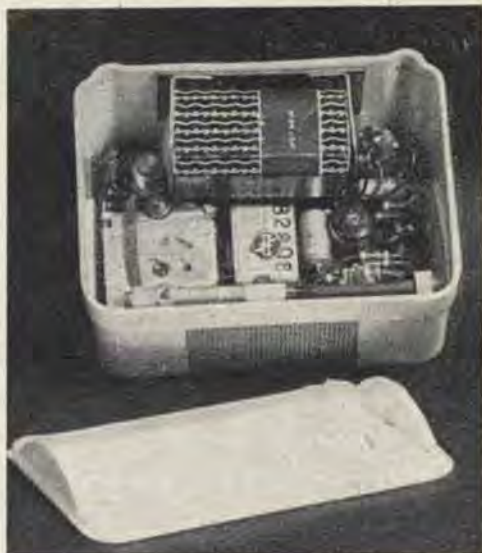
Il ricevitore alloggiato nel mobilino in plastica: in primo piano il « coperchio », o meglio, il fondello disinnestabile.
