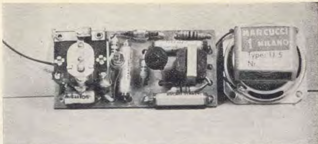
Fotografia del complessino montato su un pannellino di plastica perforata prodotta dalla ditta « Teko - Bologna »: si noti a destra il micro altoparlante « Beta U5 » distribuito in Italia dalla M. Marucci e C.
