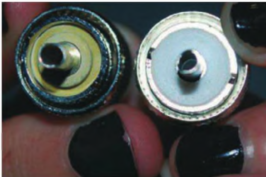
Foto D: Un par de conectores PL-259. El de la izquierda es un Amphenol. El de la derecha es uno más barato.
