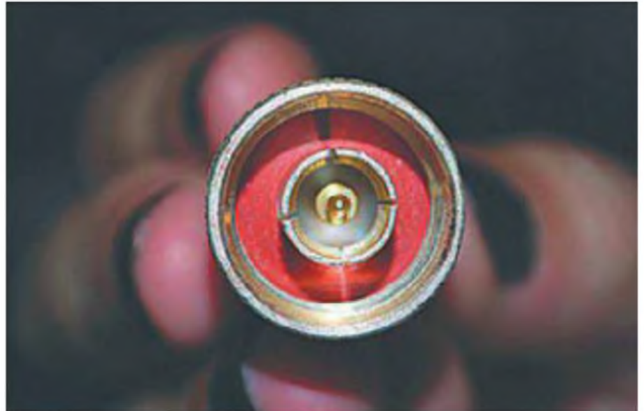
Foto F: Este es un conector N que es el más adecuado para microondas.
