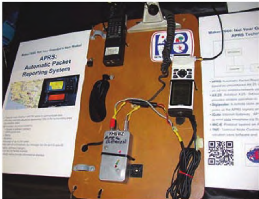
Figura 4: La baliza de APRS de KH6WZ consistía en un viejo equipo de 2 metro, una TNC TinyTrak2 de Byonics y un GPS de Garmin. Es estupendo que aún funcione este conjunto que tiene ya más de 10 años.
