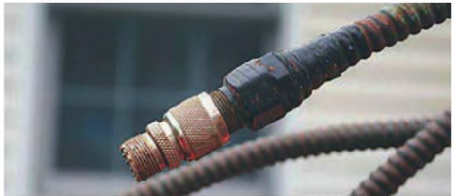
Foto C: Sección de una línea rígida hueca de 1/2" con un conector PL-259.
