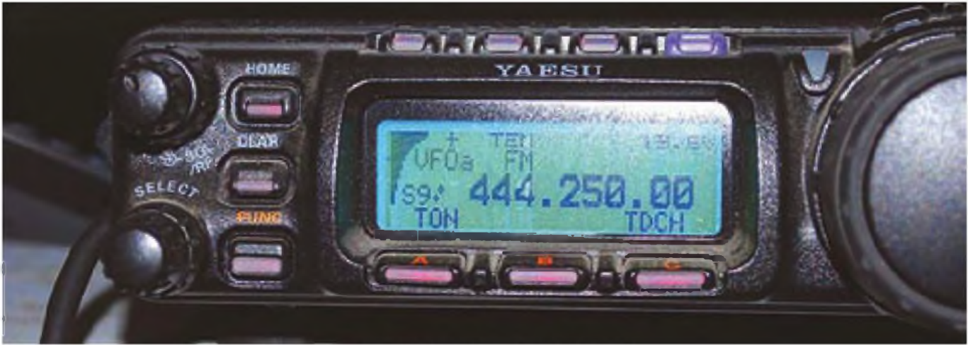
Foto B: El S-meter de un Yaesu FT-857 muestra una señal de S-9+ (Fotos B a D de KO0Z)
