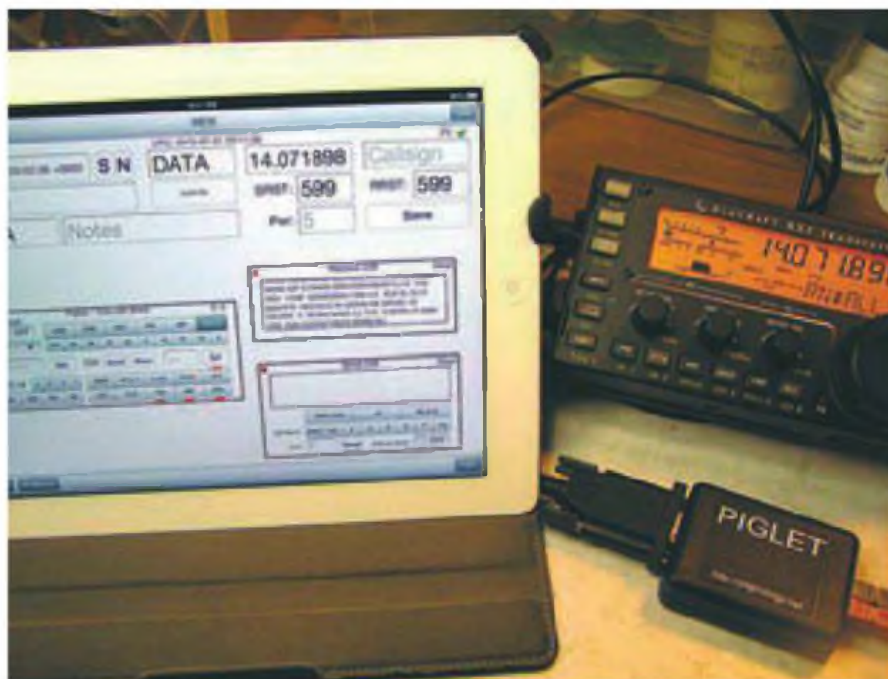
Foto C: El HamLog funcionando en un iPad, con una conexión entre el iPad y el KX3 a través de un Piglet.
