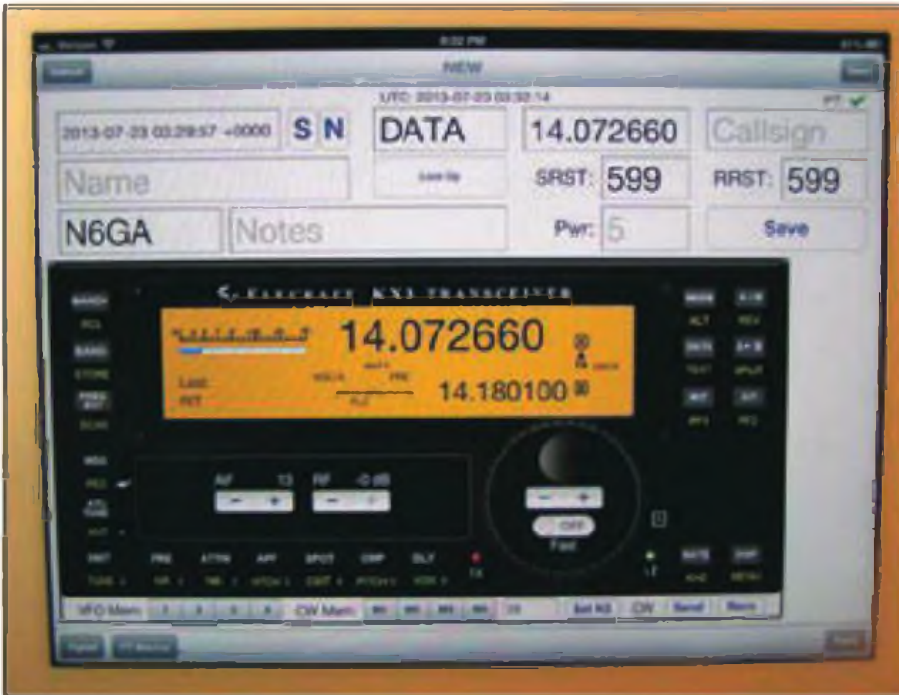
Foto E: La interface completa del KX3 con el HamLog
