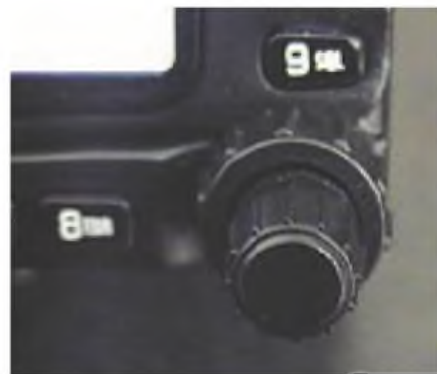
Foto C: Los controles de volumen para los dos receptores son concéntricos en un solo mando, lo que hace algunas veces que el ajuste rápido sea algo dificultoso. La empresa afirma que ha mejorado el diseño tapa con el módulo para cada banda.
