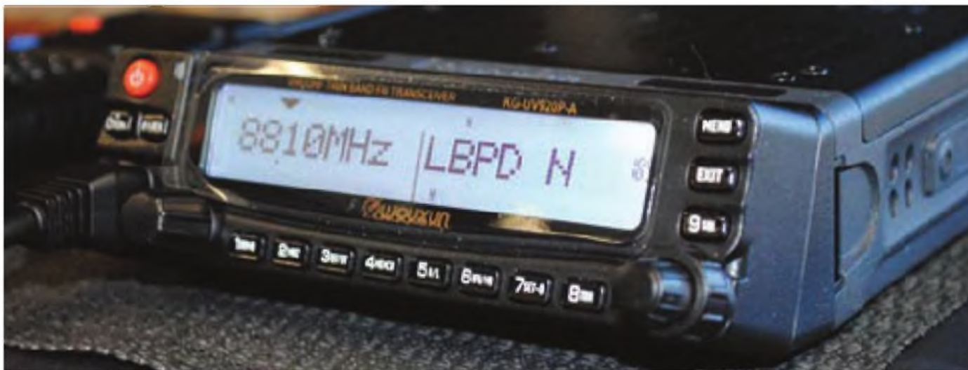
Foto A: El transceptor móvil KG-UV 920P-A es un equipo doble banda con doble pantalla y recepción en dos bandas al mismo tiempo.
