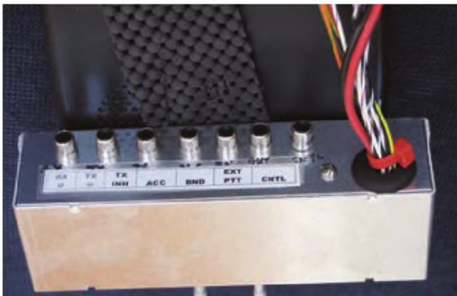
Foto H: Este es el panel posterior que muestra todos los conectores RCA de la unidad de interconexión.
