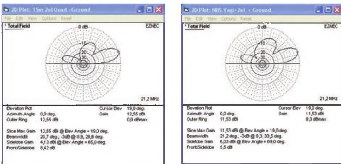
Figura 7: Lóbulo de elevación sobre tierra real de Quad y Yagi
