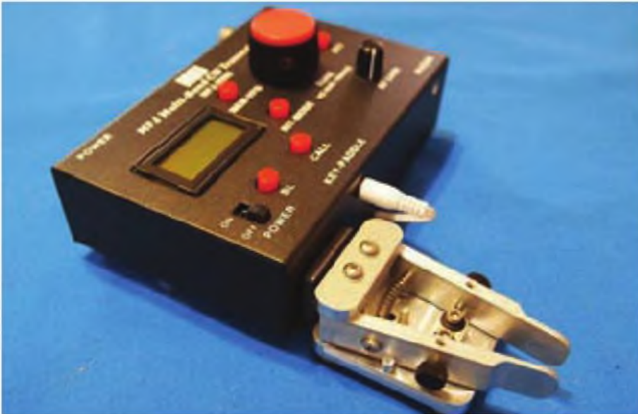
Foto D: El manipulador DCP (Dirty Cheap Paddle) se sujeta maravillosamente bien al panel frontal mediante un par de imanes y un trocito de cable, robado a un par de auriculares de un dólar. Encola cuidadosamente los imanes por un lado al equipo y por otro al manipulador.
