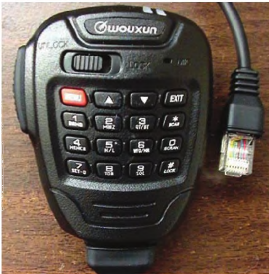
Foto D: Las teclas en el micro/altavoz son fáciles de utilizar para programar los canales simplex. Sin embargo, la programación más compleja debe hacerse mediante un ordenador. Además, el altavoz suena por la parte posterior del micro, en lugar de por la parte frontal, que es lo más habitual.
