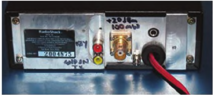
Foto B: Este es el panel posterior de un HTX-10 modificado como equipo de FI. El panel posterior y el disipador fueron rebajados y dejados planos, y nuevos conectores han sido añadidos. El conector BNC lleva ahora la transmisión RF de TX y el conector rojo RCA saca la RF de RX. El conector amarillo RCA es la puesta a masa para TX (PTT).
