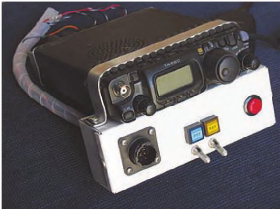
Foto G: El equipo transceptor FI incluye una caja de interconexiones que maneja todas las conexiones de control mediante conectores RCA. El pulsador rojo en el lado derecho es un manipulador de CW de reserva. El conmutador de la izquierda es para accionar el PTT. El de la derecha es un pulsador de transmisión que se utiliza para sintonizado o emitir una baliza.
