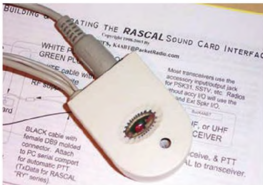
Foto A: No necesitas ningún equipo especial para trabajar las modalidades de audio digitales como el FreeDV. Esta interface simple RASCAL, que tengo desde hace años, es compacta y fiable. Buscando en Google, he encontrado unos cuantos circuitos para interfaces de audio muy simples que se pueden montar por menos de 20 $US.
