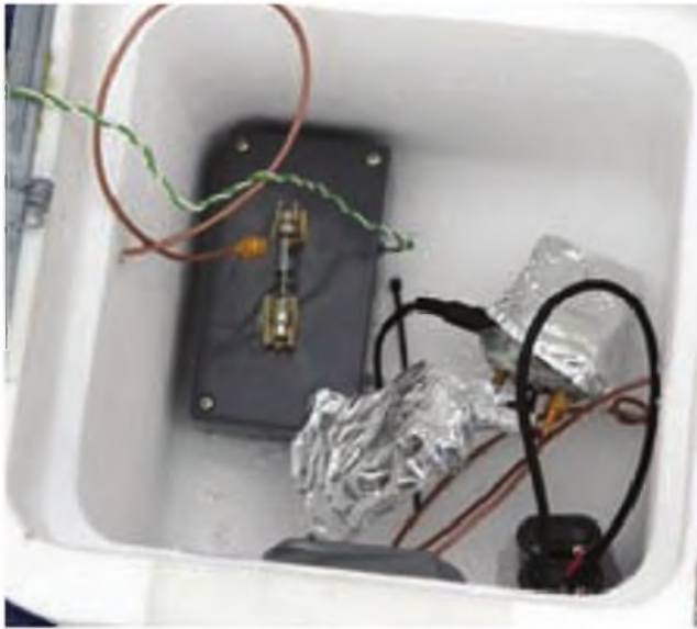
Parte de la carga útil del AiseKom 2: a la izquierda, el detector de radiaciones; a la derecha, los transceptores del repetidor de voz, con una envoltura de protección.
