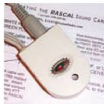
Figura 4. Interfaz básica tarjeta de sonido/radio de K4ABT. Realmente es de "conectar y usar" para cualquier equipo de radio. El autor ha empleado esta interfaz durante años. Consultar al suministrador local sobre las interfaces disponibles.
