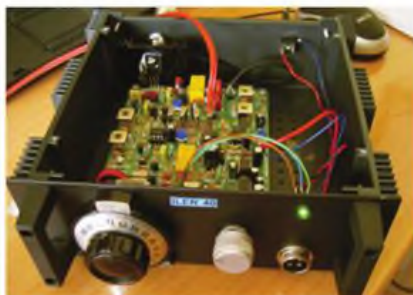
Un ejemplo de un montaje muy cuidado del ILER-40 realizado por el colega Alfons, EA3BFL
