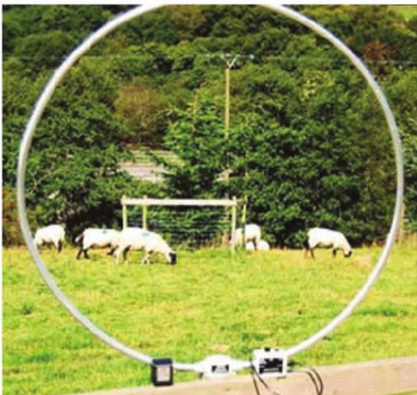
Antena ALA1530+. Foto E
