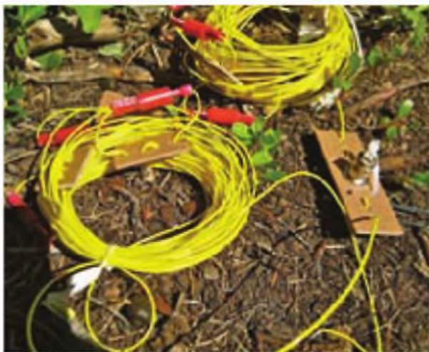
Foto B. El dipolo "segmentado" de Steve para 20, 30 y 40 metros.
