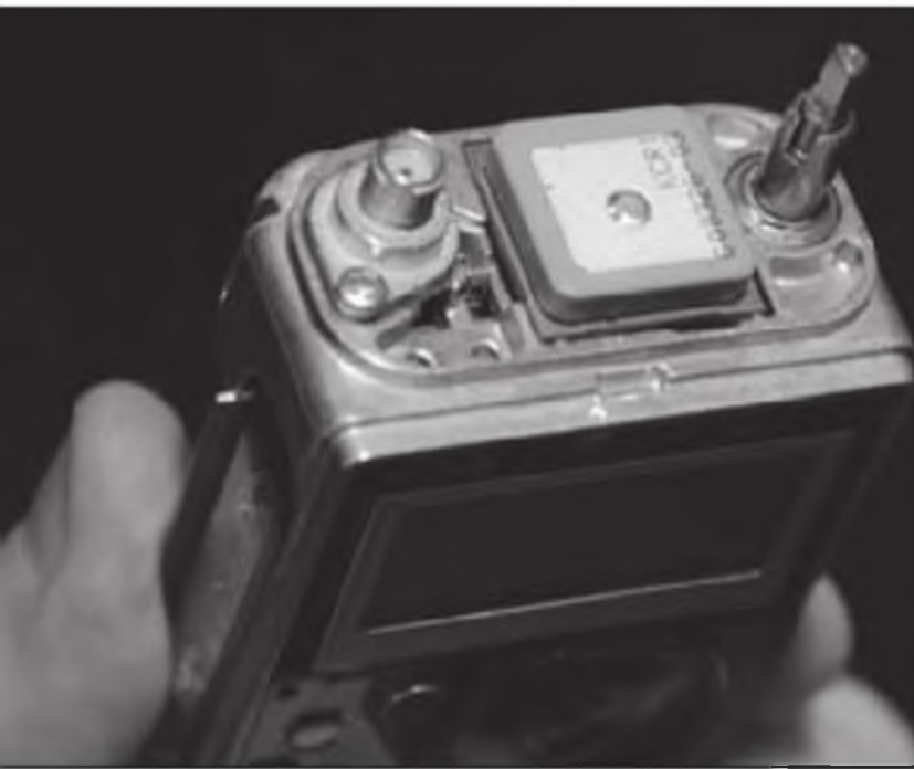
Foto E. El conector de antena del TH-D72 dispone de contactos plateados para sustituirlo sin soldadura si fuera necesario. Léete las "Prestaciones ocultas" (foto cedida por W6GPS).
