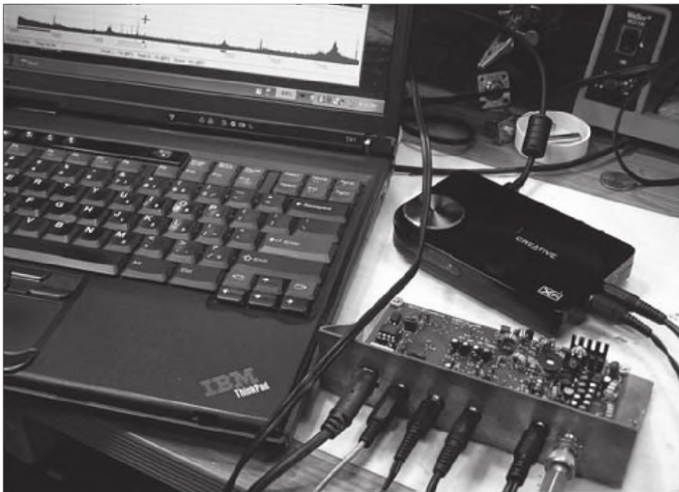
El transceptor SoftRock Ensemble con una tarjeta USB de sonido SoundBlaster Creative X-Fi y un ordenador portátil en el que corre un programa Rocky, conectados y listos para salir al aire con un vatio.
