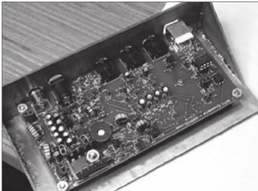
Foto A. El SoftRock Ensemble, el transceptor en kit ya montado. Véase el texto para más detalles.
