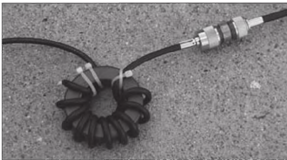
La parte inferior del dipolo vertical de Charlie, realizada con 3,40 m de cable RG-59, está a la derecha y se acopla a un cable enrollado en el choque de RF realizado con un RG-58 sobre un toroide FT240-43.
