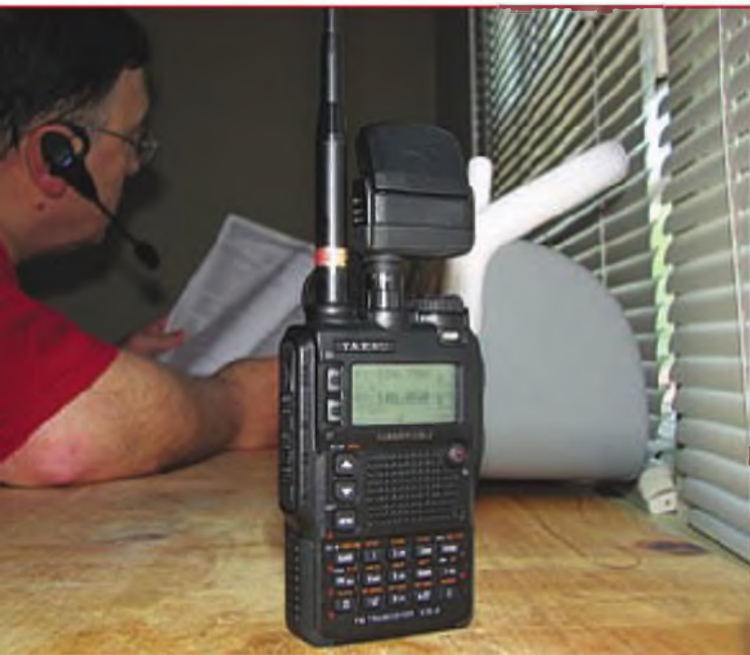
Foto C. Una manera de usar Bluetooth en casa con el VX-9DR es situar la radio cerca de una ventana donde sea óptima la recepción de un repetidor, mientras monitorizamos el canal mediante un casco-micrófono Bluetooth.
