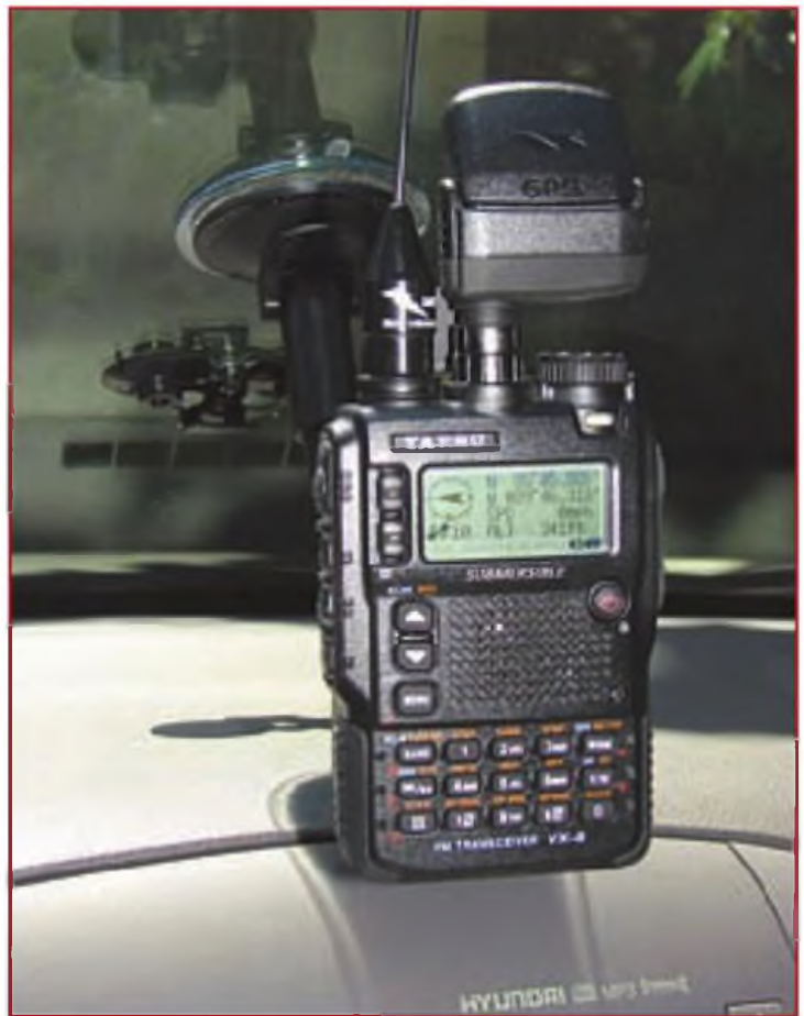
Foto B. El VX-8DR puede ser fijado al parabrisas mediante un conjunto de succión, igual que un típico receptor GPS (como en realidad, es). Mediante Bluetooth, podemos operar la radio en modo manos libres.
