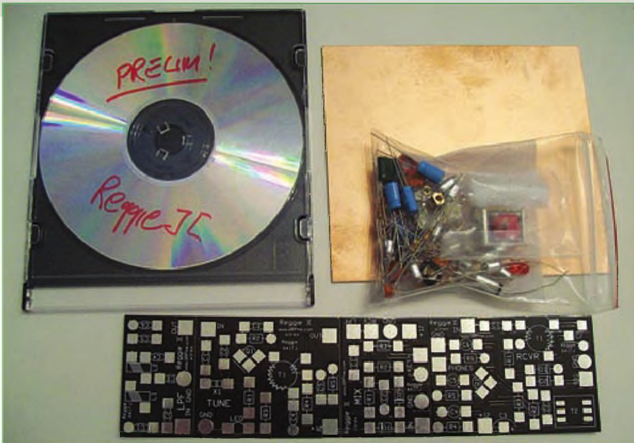
Foto E. El nuevo kit del minitransceptor Reggie II, tal como fue recibido procedente de W1REX < www.QRPme.com >. Debes empezar por montar las cuatro placas y clasificar los componentes en cuatro bolsitas, una para cada placa. Las instrucciones para su montaje vienen en un CD con el kit.
