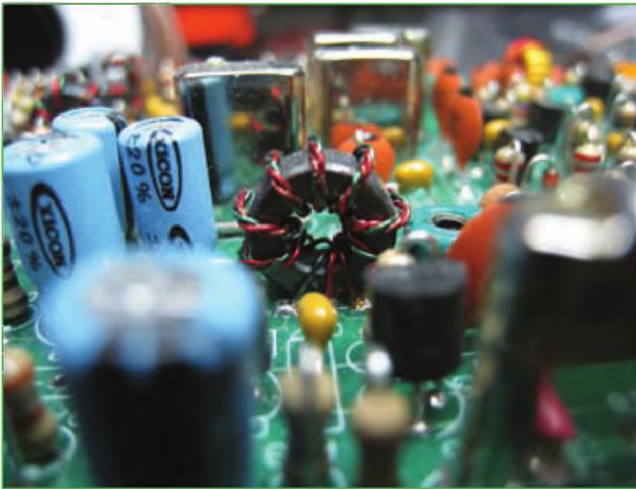
Foto D. Un toroide trifilar. Observa los tres colores diferentes retorcidos juntos y enrollados en el núcleo del toroide.
