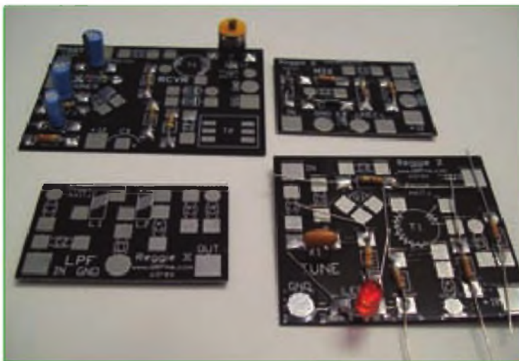
Foto F. Aquí tienes el kit Reggie II ya casi montado. He dejado algunos cables sin cortar en una placa para mostrar que primero instalo los componentes y luego corto paulatinamente las patillas durante el proceso.
