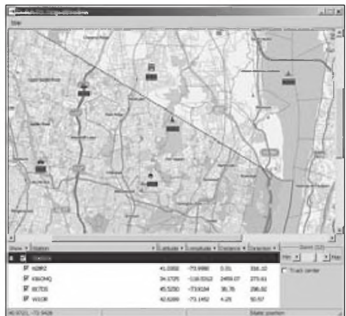
Figura 1.- El mapa que aparece en D-RATS nos muestra actividad (imaginaria) alrededor de mi QTH. Una estación puede escoger entre más de una docena de iconos, como en el APRS y, al pasar el cursor por encima de uno de ellos, se muestra una ventana con información. Los mapas son actualizados gratuitamente.
