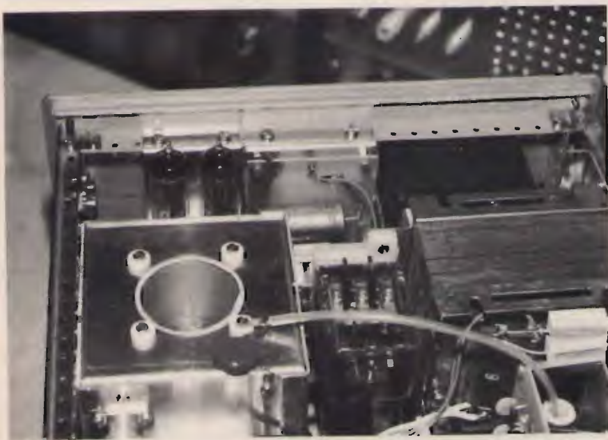
①⑦ Particolare superiore della cavità, al centro il relè a tre scambi da 10A, a destra il trasformatore per le tensioni ausiliarie e in avanti verso il pannello i due tubi 0A2.
