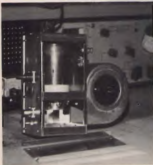
⑪ La cavità assemblata.
