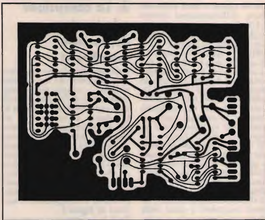
② Circuito stampato del modem manchester migliorato.
