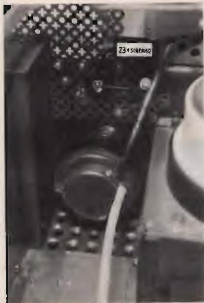
②② "Usando il solito lamierino traforato d'alluminio occorre schermare anche la Z3, sistemata sopra il Jennings di Load".
