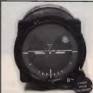
**1015018 Orizzonte artificiale Sperry** con giroscopio ad aria compressa. cm 11x11x19. In ottime condizioni **L. 25000**
