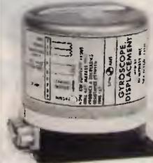
impiegato su missili, con motore a molla "Spring Motor"; la molla, una volta scarica si può ricaricare. Oggetto di grande precisione meccanica, originale USA.
