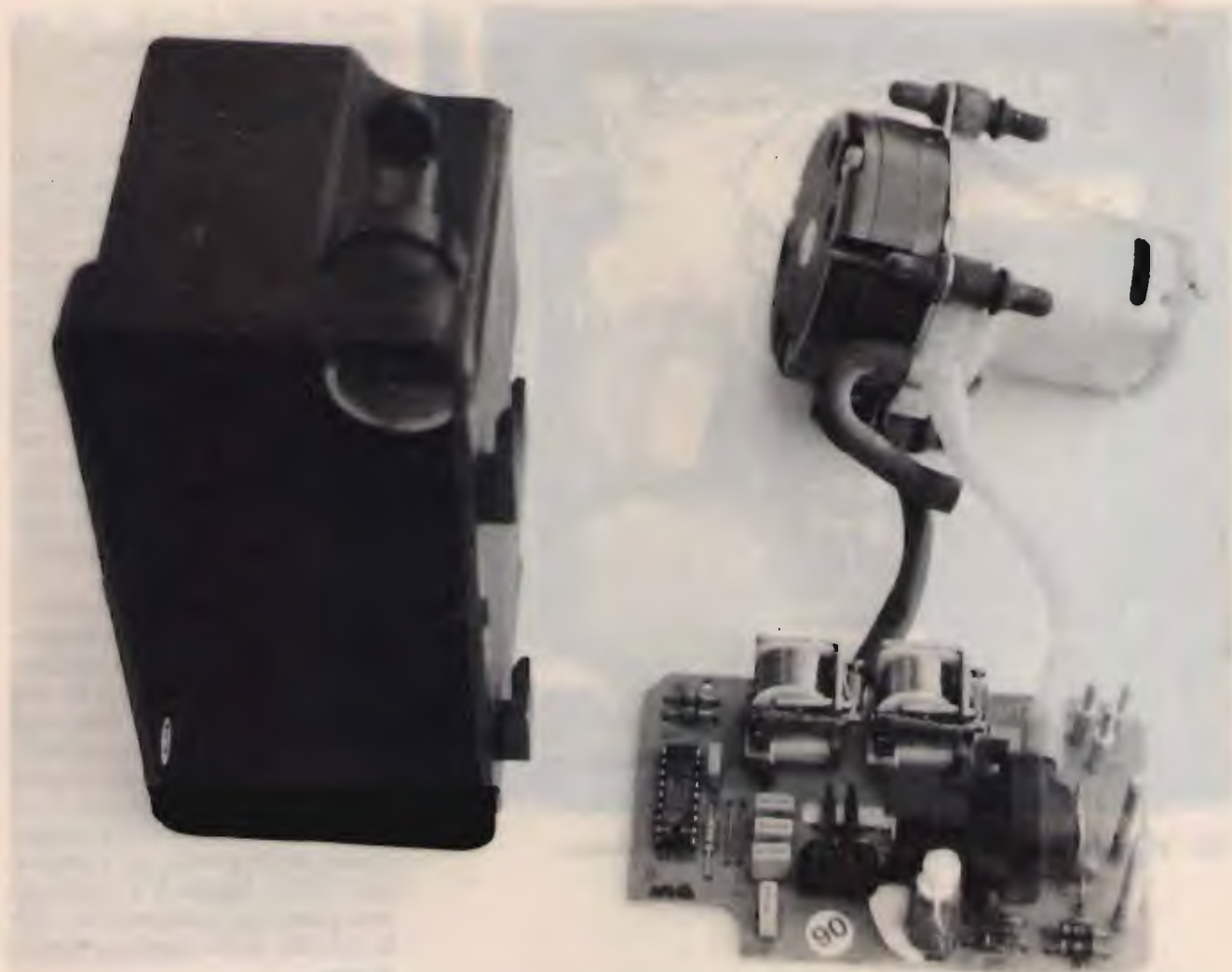
② Foto di una pompa Mercedes aperta con elettronica ben visibile.
