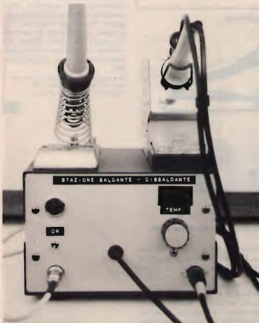
⑥ Pannello frontale della stazione dissaldante.
