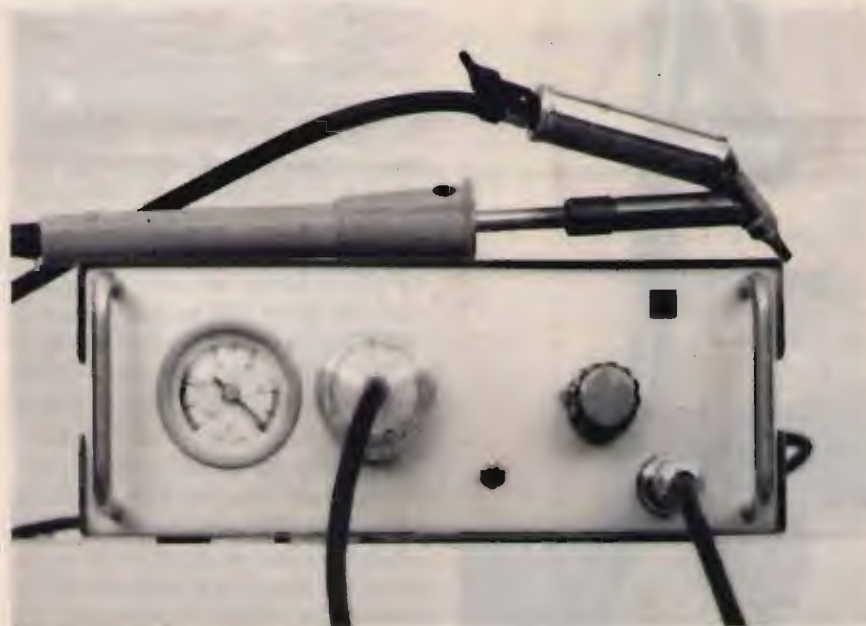
⑧ Foto di stazione dissaldante autocostruita con dissaldatore JBC.
