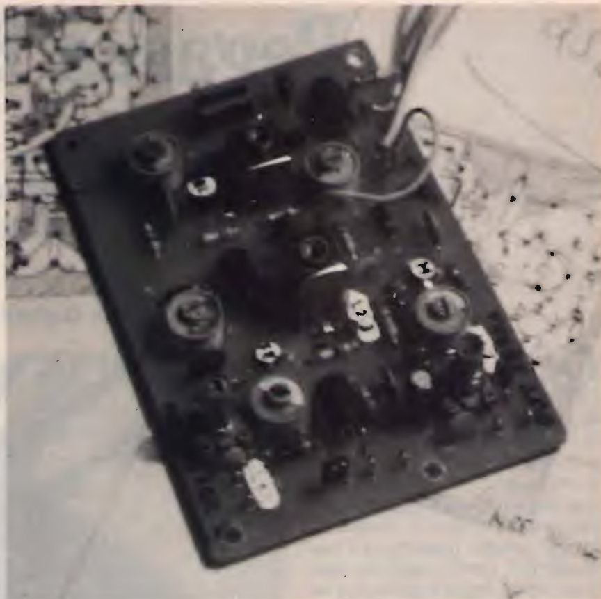
Il circuito stampato Pegasus 2° completo dei suoi componenti.
