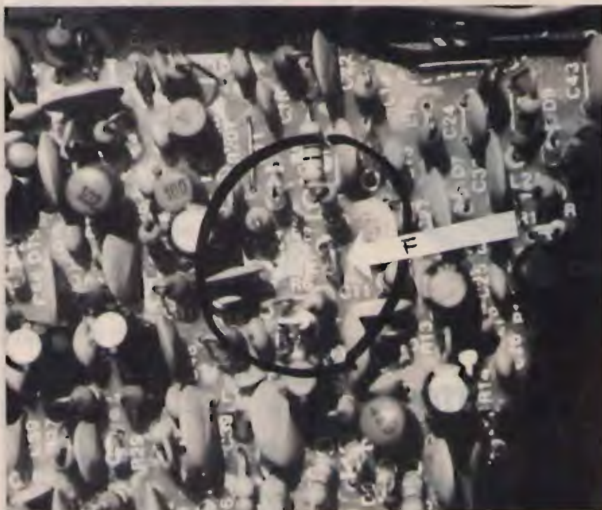
⑦ La freccia "F" indica il ponticello fatto con gli stessi reofori di R7. Attenzione: sullo schema R7 è siglata 22 Ω, in realtà il valore esatto è 220 Ω.
