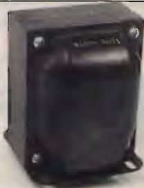
1004019 Trasformatore HP. Primario 115+115 V, 50-60 Hz. Secondari: 400V - 55mA con presa centrale; 5V - 2A; 6,3 V - 3,25A; 6,3V - 1,5A. Nuovo nell'imballo originale, completo di schema e dati. Misura mm 96x80x90 per Kg 2,5 di peso. £ 25.000
