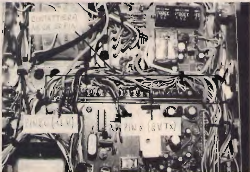
La foto permette di vedere la posizione della contattiera alla quale si deve fare riferimento per le operazioni di cablaggio.
