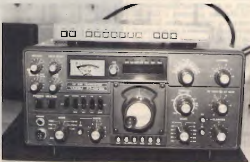
Come si presenta il VFO digitale esterno FV-707 DM abbinato all'FT 101 ZD.
