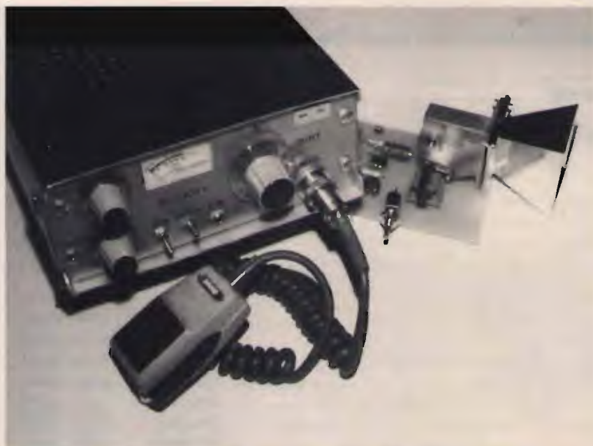
Ricetrasmittitore per 10 GHz autocostruito utilizzato con beacon.
