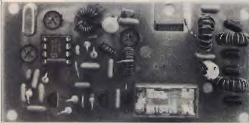
figura 5 Circuito stampato e disposizione componenti del trasmettitore.
