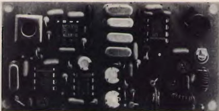
figura 4 Circuito stampato e disposizione componenti del ricevitore.
