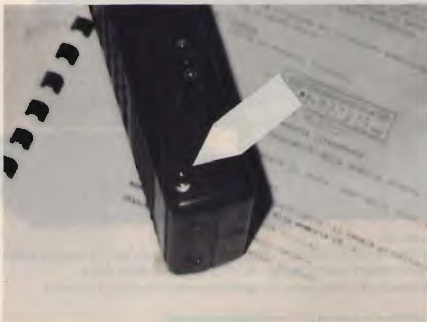
foto 1 Presa Jack aggiunta.
