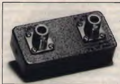
foto D Il preamplificatore per 145 MHz, con guadagno di 24 dB e cifra di rumore di 0,43 dB, impiegato dall'Autore.
