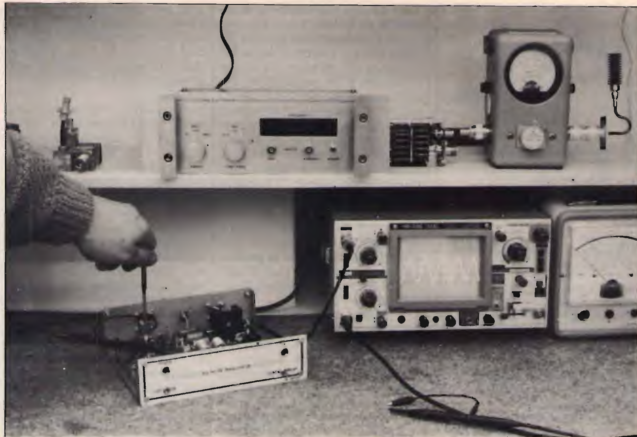
foto 4 La taratura dell'oscillatore locale.
