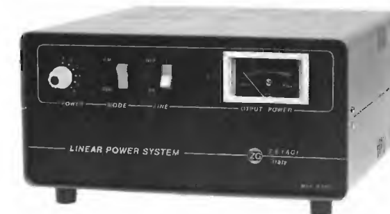
B 507 per base fissa Frequenza: 20 - 30 MHz Potenza d'ingresso: 1 - 7 W AM 15 SSB Potenza d'uscita: 80 - 300 W AM 600 SSB Alimentazione: 220 V 50 Hz Dimensioni: 310 x 310 x 150 mm
