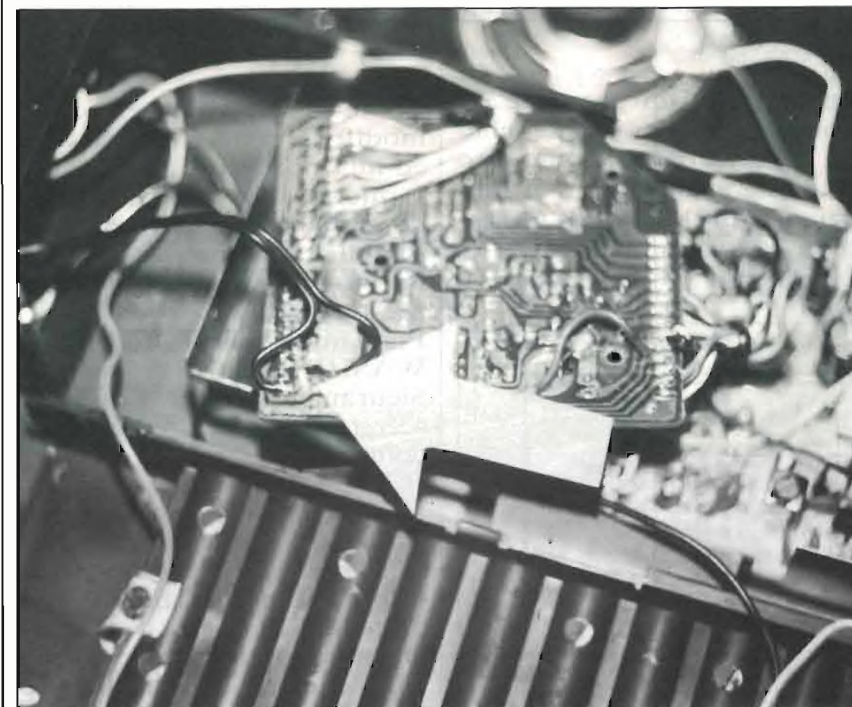
foto 2 Pista da interrompere sul PRO 2000.
