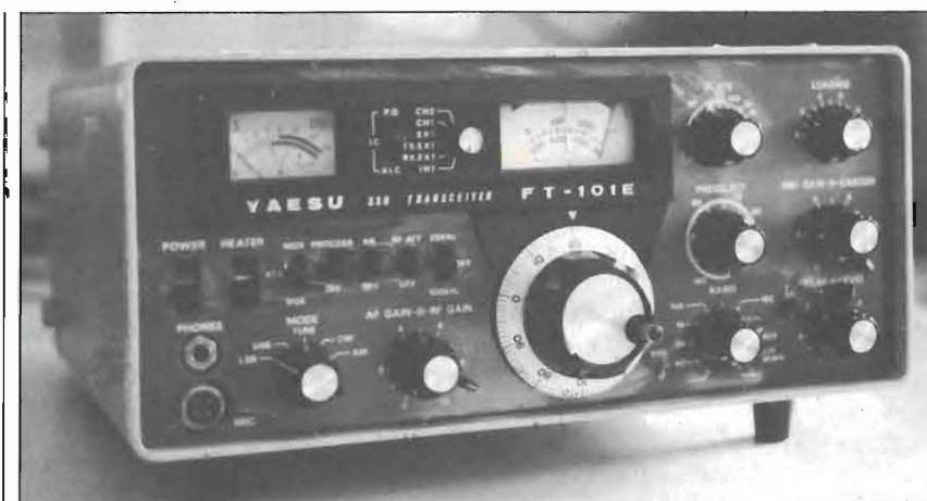
foto 11 Uno dei più "giovani" del surplus: lo FT-101E della YAESU, ancora presente in tante Stazioni. Lo FT-101E è il capostipite delle famiglie dei nuovi RX/TX transistorizzati, con finale a valvole, alimentabile anche a 12 V.
