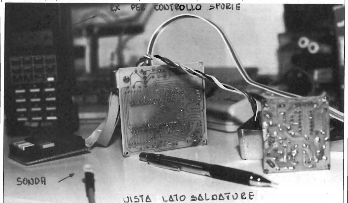
foto 5 Le basette del VCO-PLL (a destra) e della CPU (al centro) viste dal lato rame. In primo piano, la sonda-spira.
