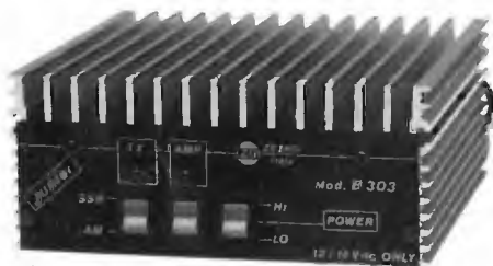
B 303 per mobile Frequenza: 3 - 30 MHz Potenza d'ingresso: 1 - 6 W AM 12 SSB Potenza d'uscita: 70 - 150 W AM 300 SSB Alimentazione: 12 - 14 V 20 A Dimensioni: 165 x 160 x 70 mm
