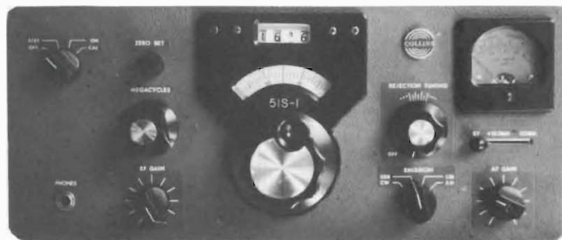
foto 1 Il Collins 51S-1, ricevitore a sintonia continua da 0 a 30 MHz.
