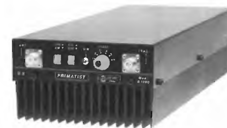
B 1200 per mobile Frequenza: 3 - 30 MHz Potenza d'ingresso: 1 - 7 W AM 14 SSB Potenza d'uscita: 150 - 1200 W AM 2KW SSB Alimentazione: 24 - 28 V 60 A Dimensioni: 200 x 500 x 110 mm
