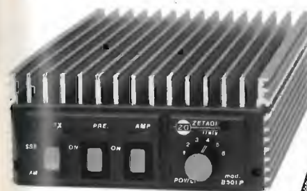
B 501 P per mobile Frequenza: 3 - 30 MHz Potenza d'ingresso: 1 - 10 W AM 20 SSB Potenza d'uscita: 70 - 300 W AM 500 SSB Preamplificatore incorporato Alimentazione: 24 - 28 V 24 A Dimensioni: 260 x 160 x 70 mm
