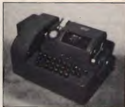
foto 6 Una CX-52-D montata sulla base B-621 a formare l'apparecchio elettronico a tastiera BC-621.
