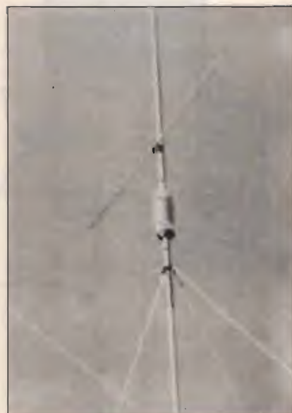
foto 2 La sezione di risonanza dell'antenna, con la bobina e la capacità orizzontale.
