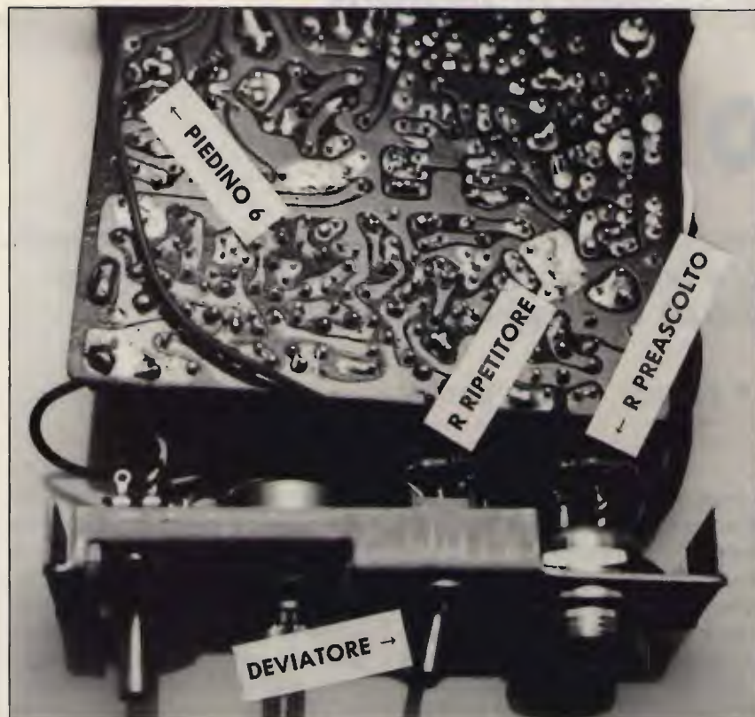
figura 5 Localizzazione delle modifiche descritte: (in alto) sul circuito stampato; (in basso) dal lato componenti di un RTX commerciale.
