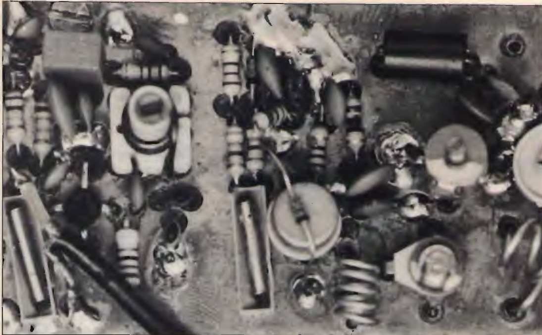
foto 2 Particolare della piastrina PA-TX: primo e secondo stadio.
