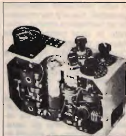
figura 9 Il ricetrasmittitore portatile giapponese "Model 94 Type 6", operante tra 24 e 49 MHz. Piuttosto ingombrante, aveva una potenza di soli 0,5 watt; l'antenna era una verticale di 1,5 metri.
