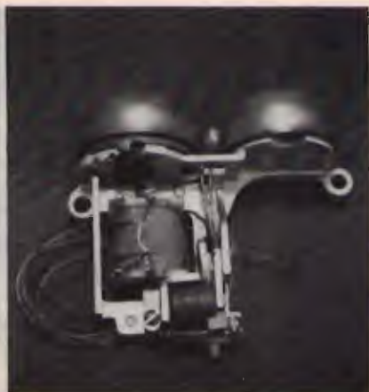
figura 14 Suonerie elettromeccaniche a una (A) e due campane (B).
