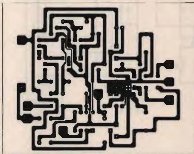
figura 2 Schema del circuito stampato in scala 1:1.
