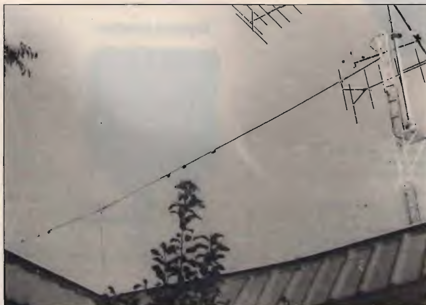
Andromeda va tesa il più orizzontalmente possibile, per evitare deformazioni del lobo di irradiazione.
