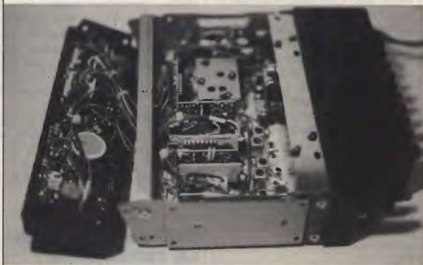
foto 7 Così bisogna smontare l'apparecchio per poter accedere al circuito per fare la modifica.
