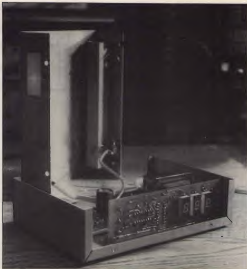
foto 5 Il telaietto visualizzatore va montato a ridosso del pannello frontale, in corrispondenza della finestrella.
