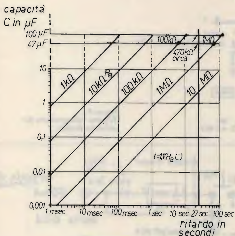
figura 2 Per calcolare il trimmer T in funzione del condensatore C. Dati sul 555 da "Il 555", Jackson pagina 2.4.
