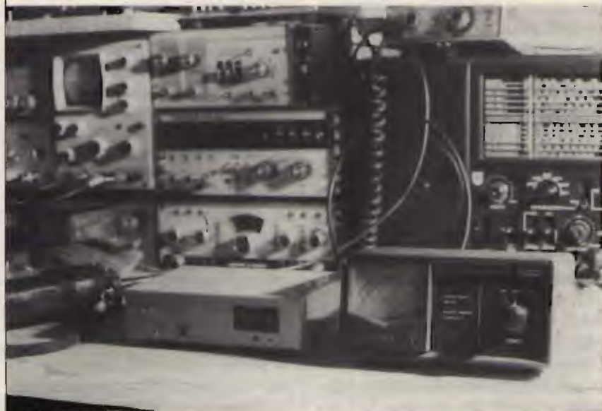
foto 6 Se ben tarato, il Pyxis visualizzerà, in forma numerica, la potenza del TX. Nella foto si controlla che il valore indicato dallo strumento (8.0 W) corrisponda con l'indicazione fornita da un wattmetro tradizionale.
