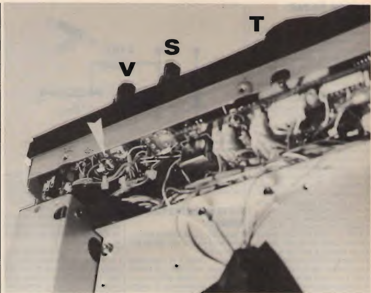
foto 4 Visione parziale del frontale, visto da sotto e da dietro. T è la manopola della sintonia; S quella dello Squelch/Tone; V quella del volume (AF/RF Gain), sul cui retro andremo ad agire per la modifica audio descritta nel testo. La freccia indica la resistenza aggiunta, molto più visibile in foto 5.
