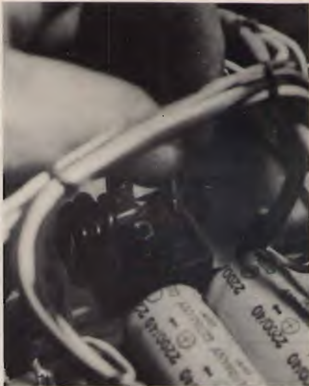
foto 4 Per connettere il ponte di diodi di potenza BC80/C20 al circuito, si utilizzeranno gli appositi "clips".
