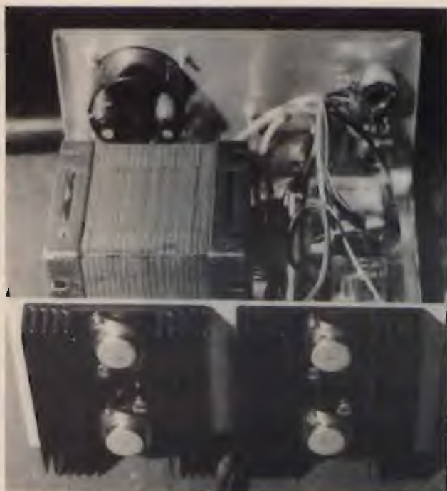
foto 2 Il trasformatore occupa gran parte dello spazio. I transistori di potenza devono essere dotati di estese alette di raffreddamento.
