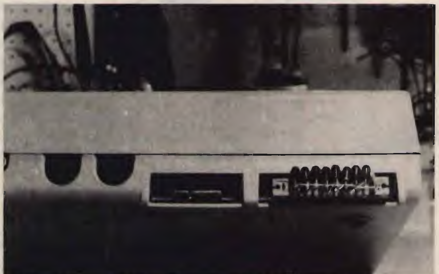
foto 2 Come collegare l'interfaccia alla User Port del C-64.
