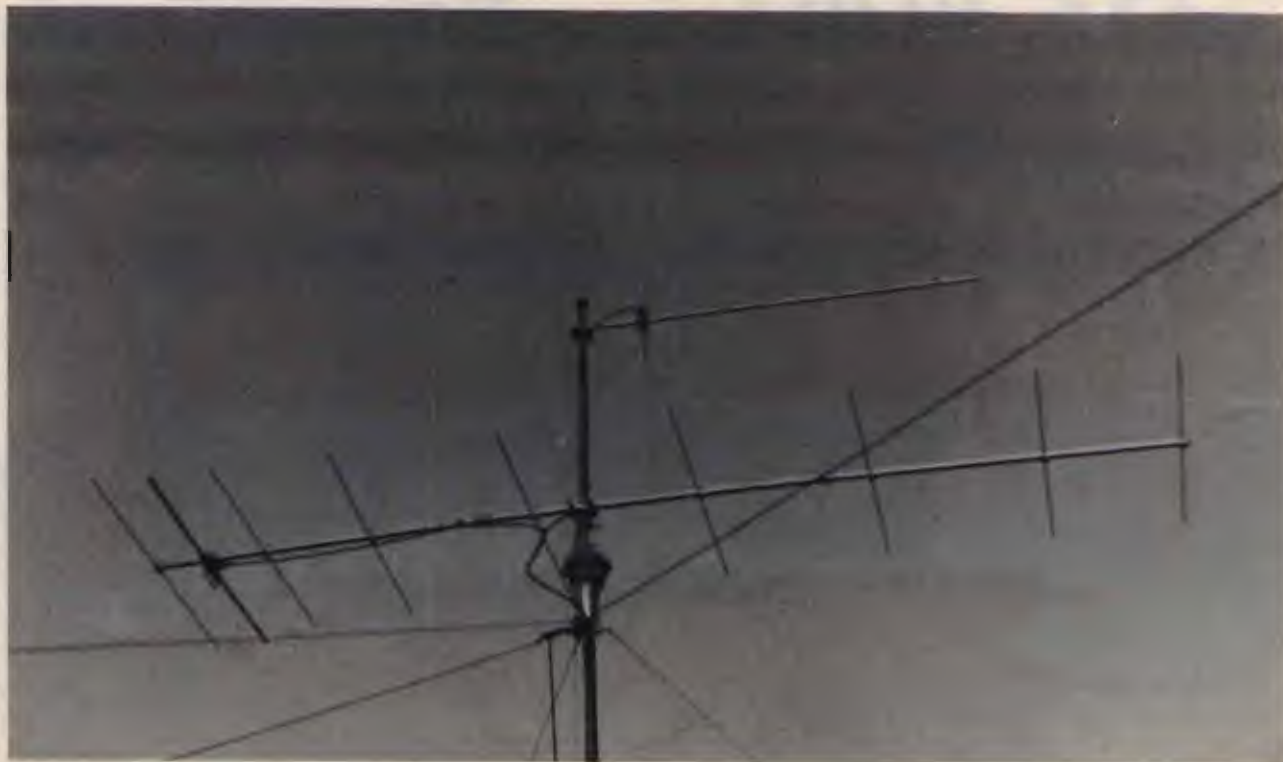
foto 6 La Fracarro 10 RA sopra la 9 elementi Tonna per i 2 metri.
