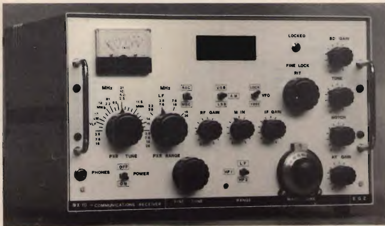
Un altro esemplare di DX 10 con la variante di un unico comando di RANGE, invece dei due precedenti utilizzati nel prototipo; differente è anche lo strumento Smeter, a scala più ampia e illuminata.
