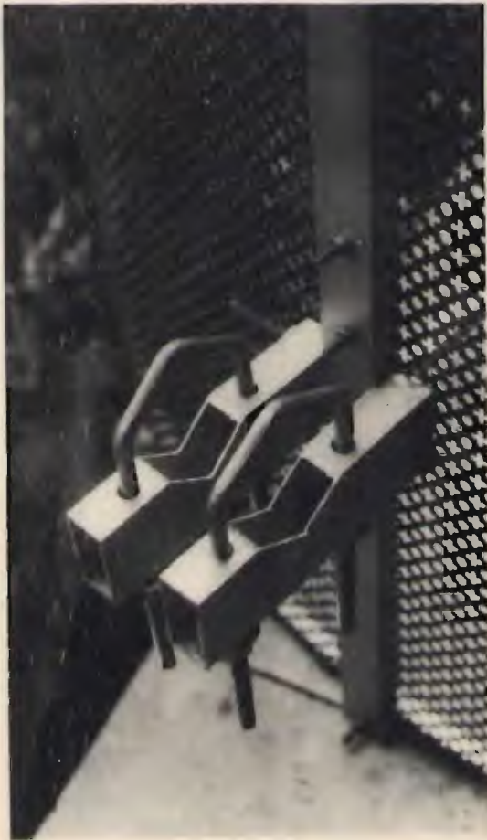
foto 8 Per fissare stabilmente l'antenna al palo di sostegno ci serviremo di due spezzoni di alluminio o ferro trafilato opportunamente sagomati (pezzi P e Q). Essi andranno ancorati alla barra di ferro trafilato montata a ridosso, in corrispondenza, del pezzo N di sostegno.
