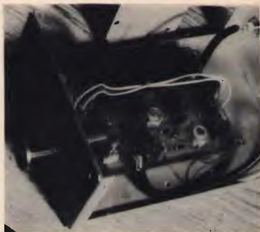
Per ottenere un funzionamento corretto, è importante schermare accuratamente i vari stadi tra loro con delle lastrine di vetronite.
