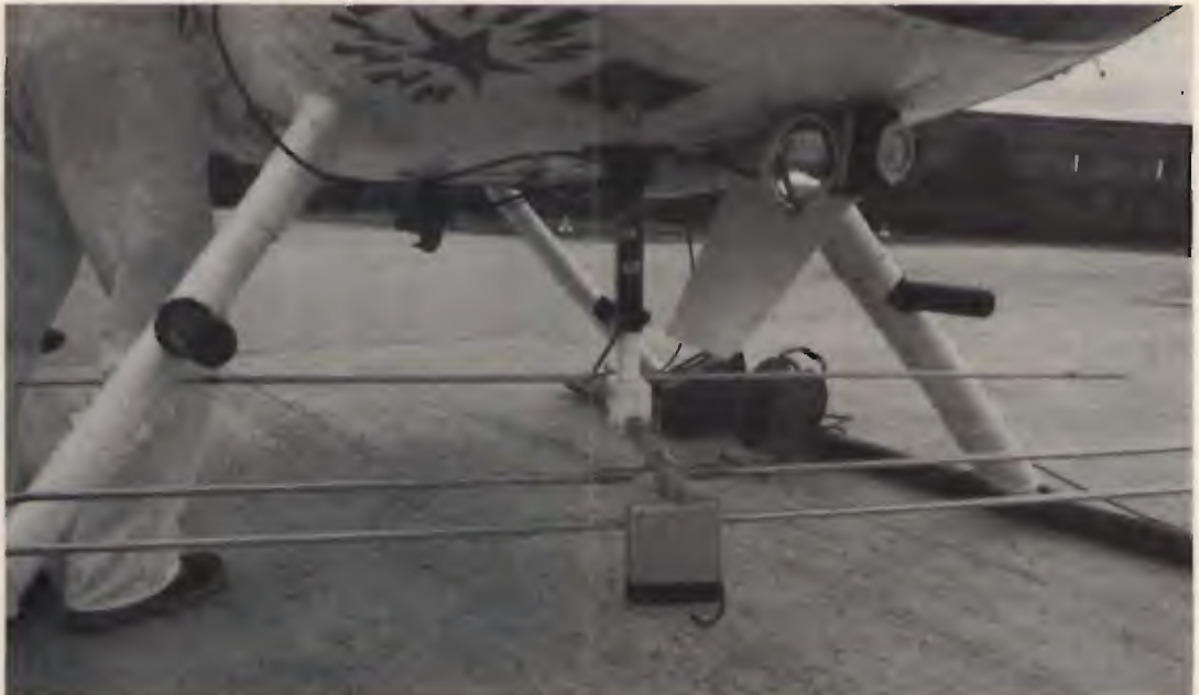
figura 5 L'antenna orientabile dell'elicottero posta sotto la fusoliera.
