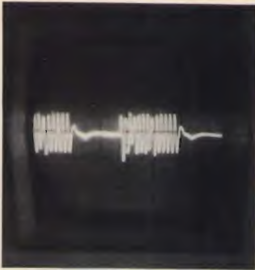
foto 7A Il segnale BF prelevato all'uscita del RX e inviato all'ingresso del Decoder. Da notare la notevole deformazione introdotta dagli stadi amplificatori BF del ricevitore.
