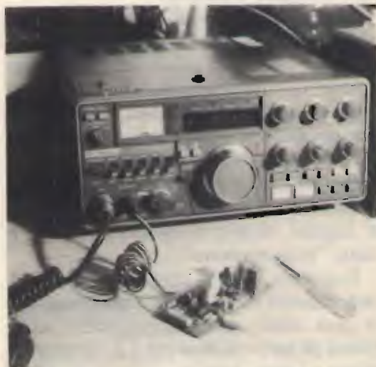
foto 8 Il Decoder, in fase di taratura, collegato a un Kenwood TS780.
