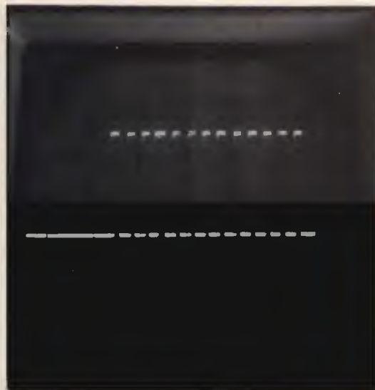
foto 2 Analisi di un singolo treno di impulsi. Il primo impulso non può essere modificato in lunghezza. Da notare, invece, il quarto e l'ottavo che risultano più lunghi (iniziano in anticipo).
