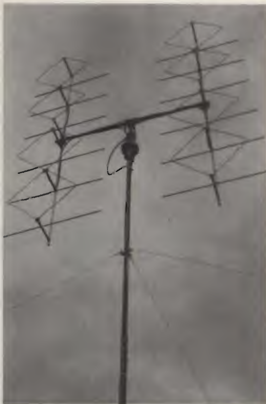
Le quattro "padelle" accoppiate di Marco, I4DWI. Da notare che queste sono state realizzate distanziando i quad dal boom.
