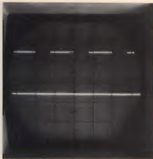
foto 1 Immagine oscilloscopica della sequenza dei treni di impulsi generati dal Coder. La sequenza si ripeterà finché il pulsante sarà tenuto pigiato.
