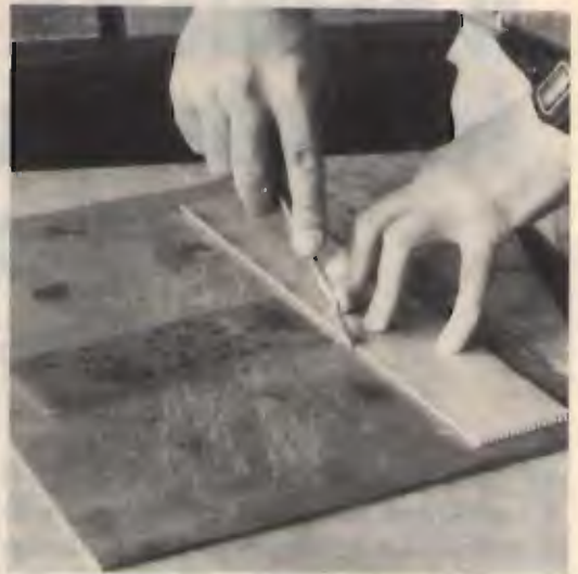
Figura 2 Con un righello metallico, una lama ben affilata e una tavoletta di legno, si porta il trasparente alle dimensioni definitive.
