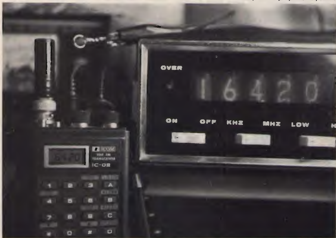
Foto n. 5 Si prova la frequenza superiore.
