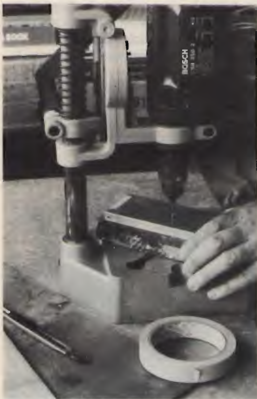
figura 3 Fissato provvisoriamente il trasparente al pannello con del nastro adesivo, si forano entrambi con una punta da 1,5 o 2 mm, in corrispondenza dei centri dei fori definitivi.
