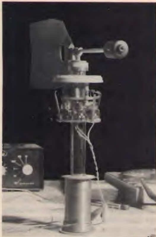
Si assembla la circuiteria dell'interruttore "esclusivo". Notare l'interposizione del tappo plastico del contenitore già inserito tra magnetino e contatti reed.
