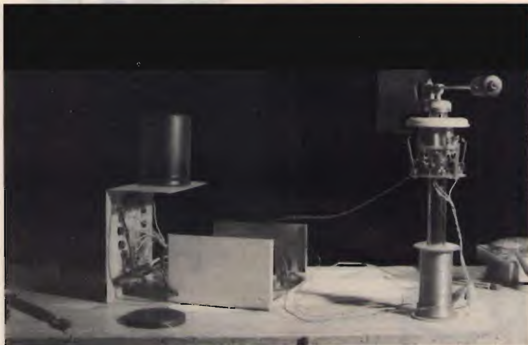
Sul banco di prova si collauda l'indicatore tarando i trimmer dell'interruttore "esclusivo" fino ad accendere i led relativi all'esatta direzione assunta dal timone.
