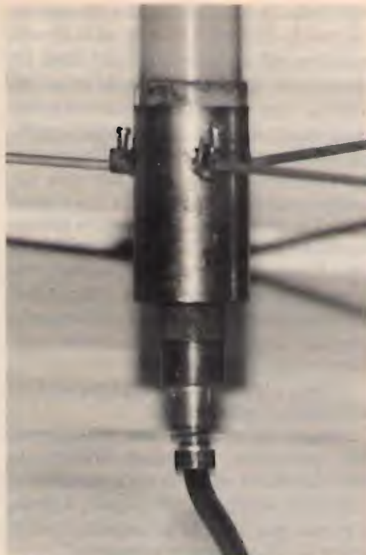
figura 4 Vista della base dell'antenna, senza l'accessorio per il fissaggio al palo.
