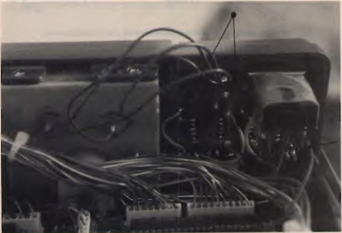
Le frecce indicano i due ponticelli A e B, e il filo che va al piedino 13 di IC8.
