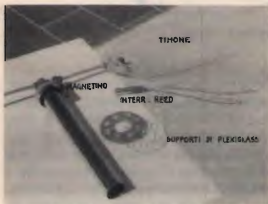
La costruzione meccanica dell'indicatore di direzione è quasi ultimata. I dischi di plexiglass visibili sulla destra faranno da supporto agli interruttori reed.
