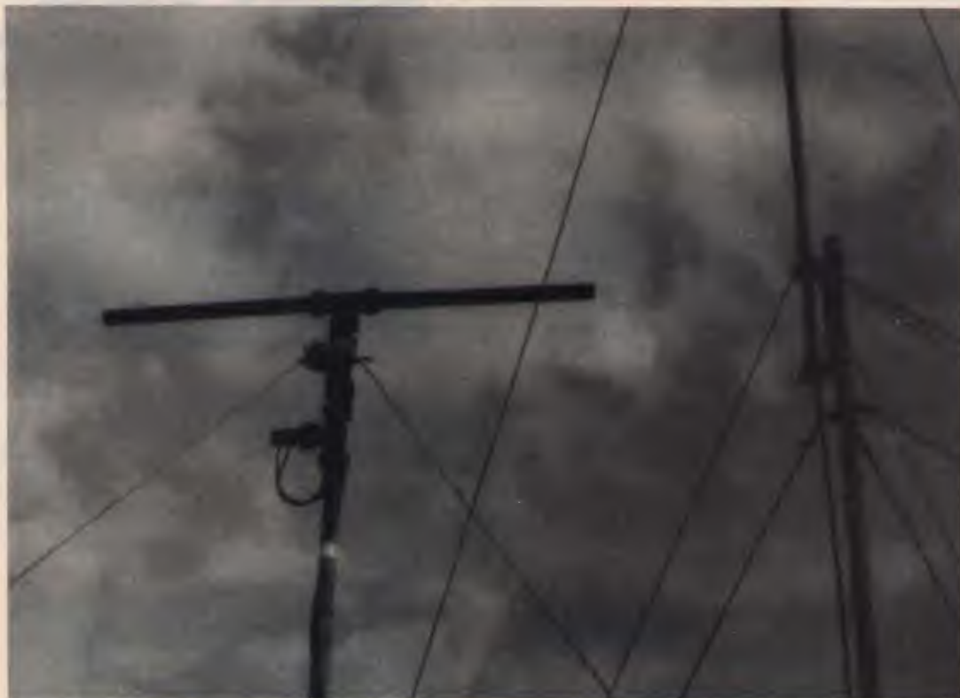
Vista più dettagliata dell'elemento ricevente e della propria struttura di sostegno, l'albero dell'antenna, e relativo elemento ricevente, ruotano liberamente all'interno del manicotto, che è bloccato dai tre tiranti, in corda nautica (e quindi fisso).
