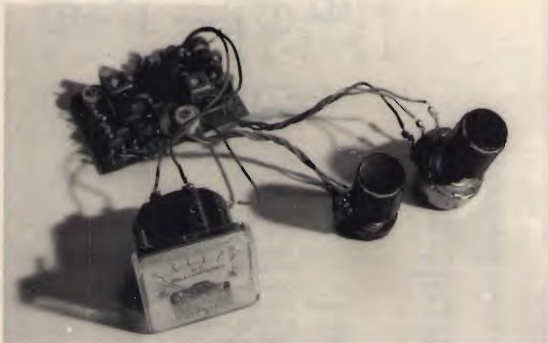
Il modulo n. 4 è il "cuore" del ricevitore "Rho Ophiuchi". Ad esso fanno capo i circuiti relativi alla rivelazione, allo squelch, al controllo di volume e allo strumentino S-meter.
