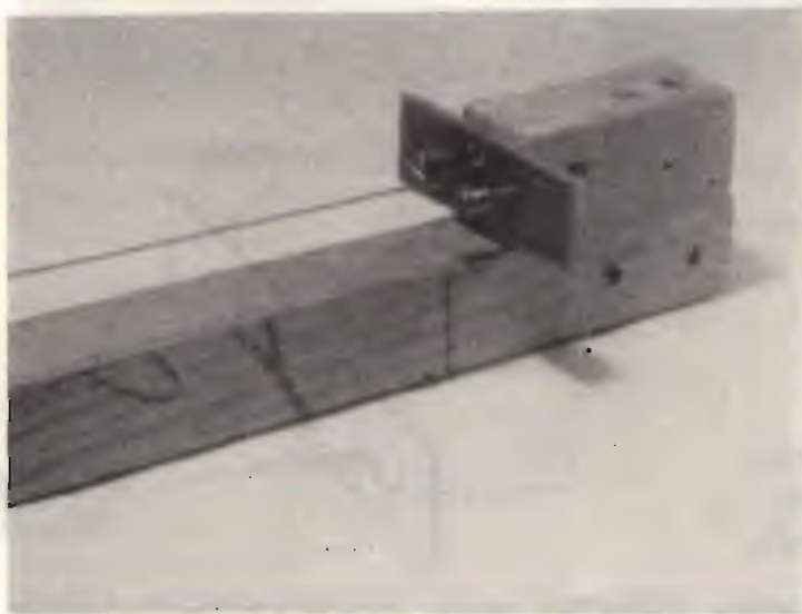
Il blocco di ancoraggio di sinistra con le viti tira-filo.
