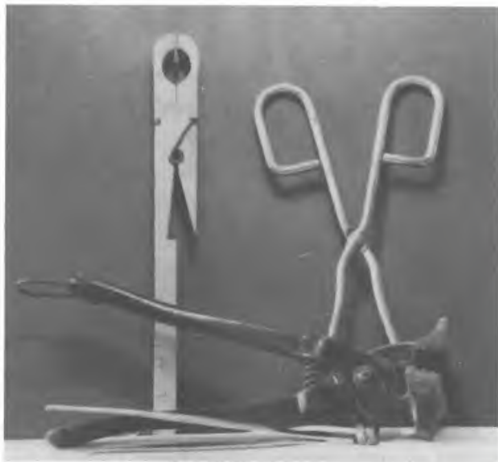
Quattro tipi diversi di pinze per la corretta manipolazione di sostanze chimiche anche pericolose. Quelle di legno servono principalmente per le provette, le altre anche per tutti gli altri recipienti.
