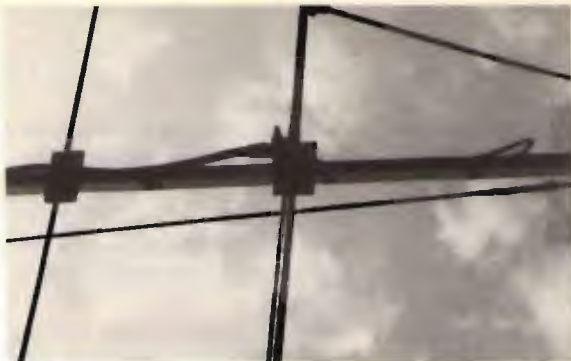
Il radiatore e il primo direttore (a destra). Molto importante la loro distanza per il migliore ROS.
