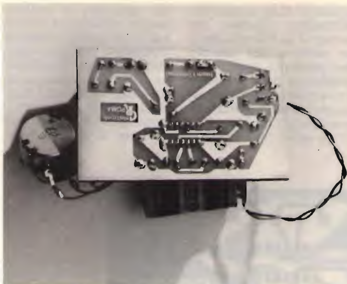
Circuito stampato del trasmettitore "Alfa Geminorum"
