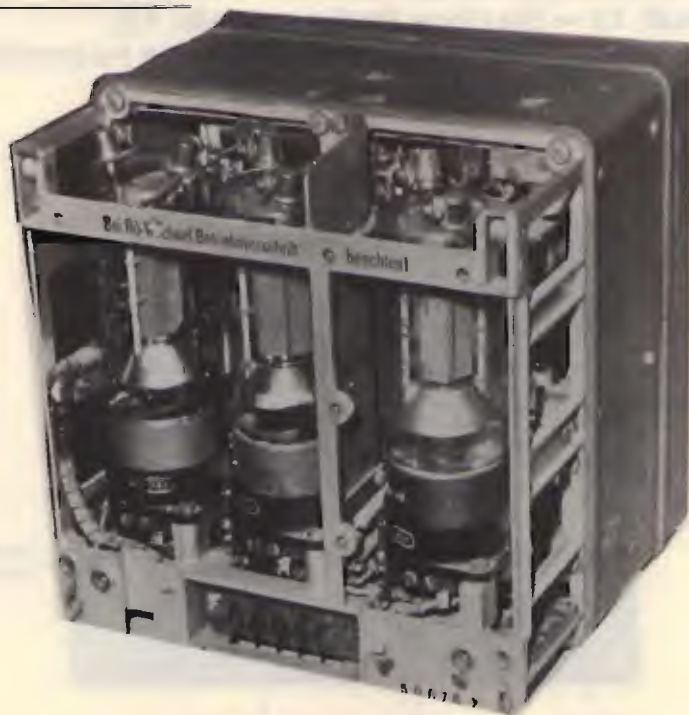
Il trasmettitore S 10 K: sono ben visibili le tre valvole RL12P35.
