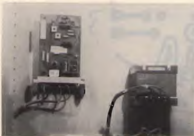
L'interruttore automatico di carica (l'etichetta con la tensione è naturalmente da sostituire con quella 120 V), siglato «M.C.S.».
