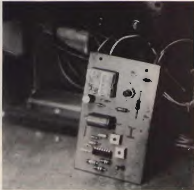
Un'altra scheda di interruttore automatico di carica, versione 24 V.
