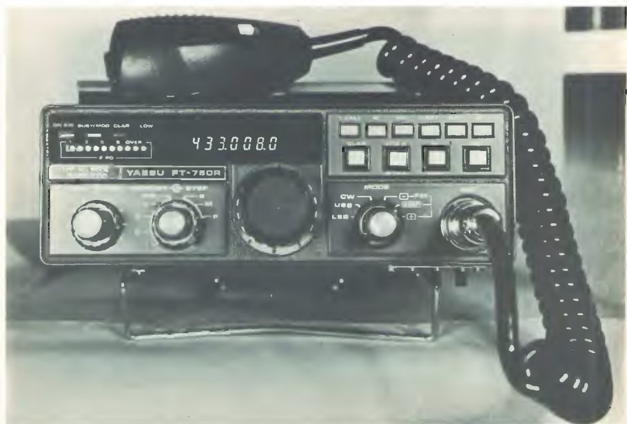
FT-780R. Si notino in basso a destra i tre selettori accennati nel testo: SAT; SCAN; BURST.
