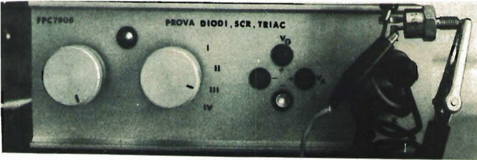
SCR in prova nel terzo quadrante.
