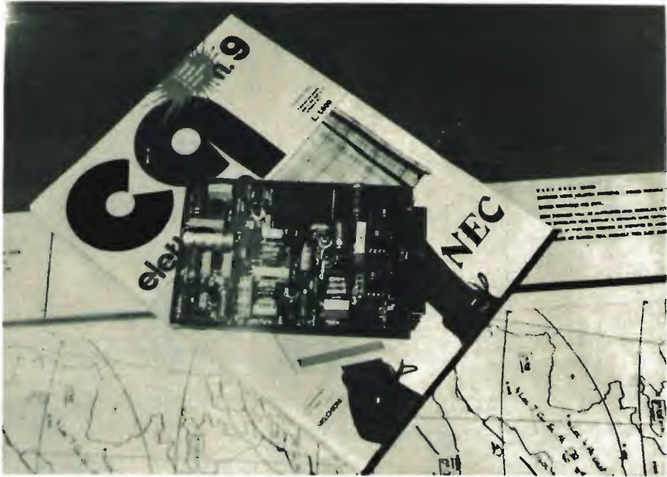
figura 2 Circuito stampato dello RTTY Test Generator.
