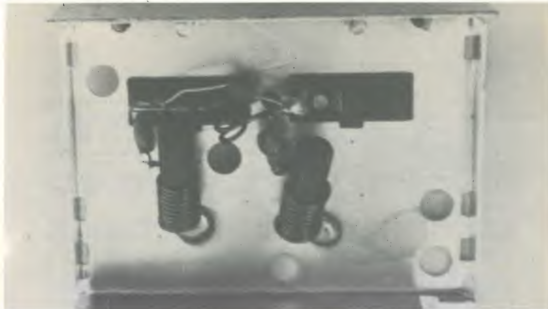
foto 7 Filtro per FM Teko, preparato per attenuare tutto lo spettro 88 ÷ 108 MHz (vista interna).
