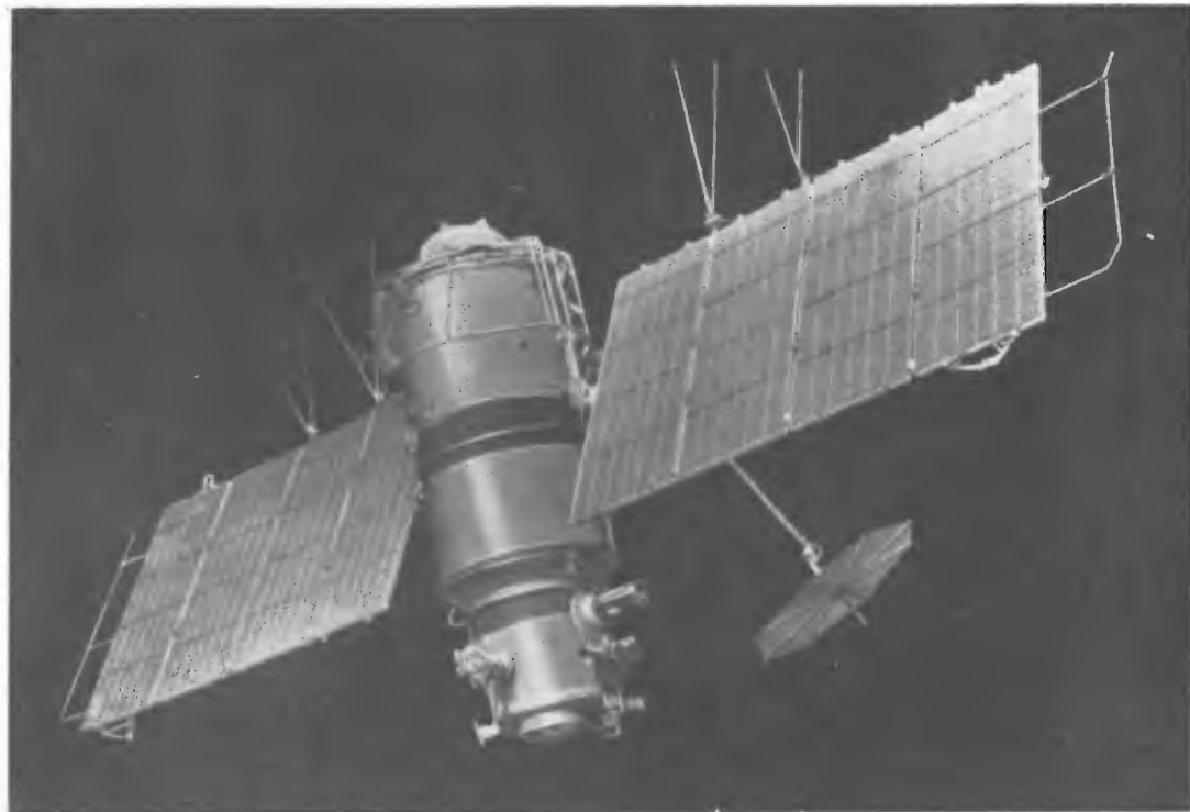
Satellite METEOR; il satellite è composto da un corpo cilindrico del diametro di 1,2 m e della lunghezza di 3 m stabilizzato sui tre assi. Sono ben visibili anche i due bracci a pannelli della lunghezza totale di 7,5 m contenenti le celle solari per la ricarica degli accumulatori di bordo. Il sistema di ripresa è a radiometro e viene comandato da terra attraverso l'antenna a ombrello in banda SHF.
