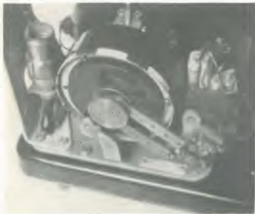
Particolare del motore; si osservino le molle-spazzole del regolatore, il bersaglio ottico per la taratura con il diapason e la rotellina sporgente per la variazione di velocità.
