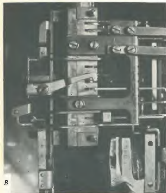
Può essere talora utile disporre la macchina per farla tornare da « cifre » in « lettere » ogni volta che si preme o si riceve il carattere « space ». La figura A mostra la posizione della apposita levetta (si trova nella parte superiore, sotto) per il funzionamento normale, la figura B invece raffigura la posizione per il ritorno automatico in « lettere ».
