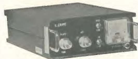
AMPLIFICATORE RF 30 W LINEARE da 27 a 30 MC
