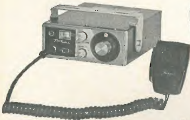
TC-5008 11 m - AM - 5 W - 23 canali - Doppia conversione con S-meter - 17 trans. - 1 Fet - 9 Diodi - 1 Thermistor - Alimentazione 12 Vc.c.
