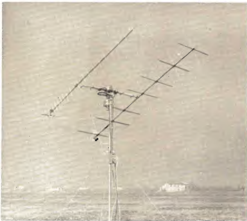
Vista d'insieme del montaggio dell'antenna LERT effettuato dal signor Graziani mediante due rotori della STOLLE. L'antenna più piccola è per la ricezione dei satelliti in banda 400÷430 MHz, anch'essa della LERT.
